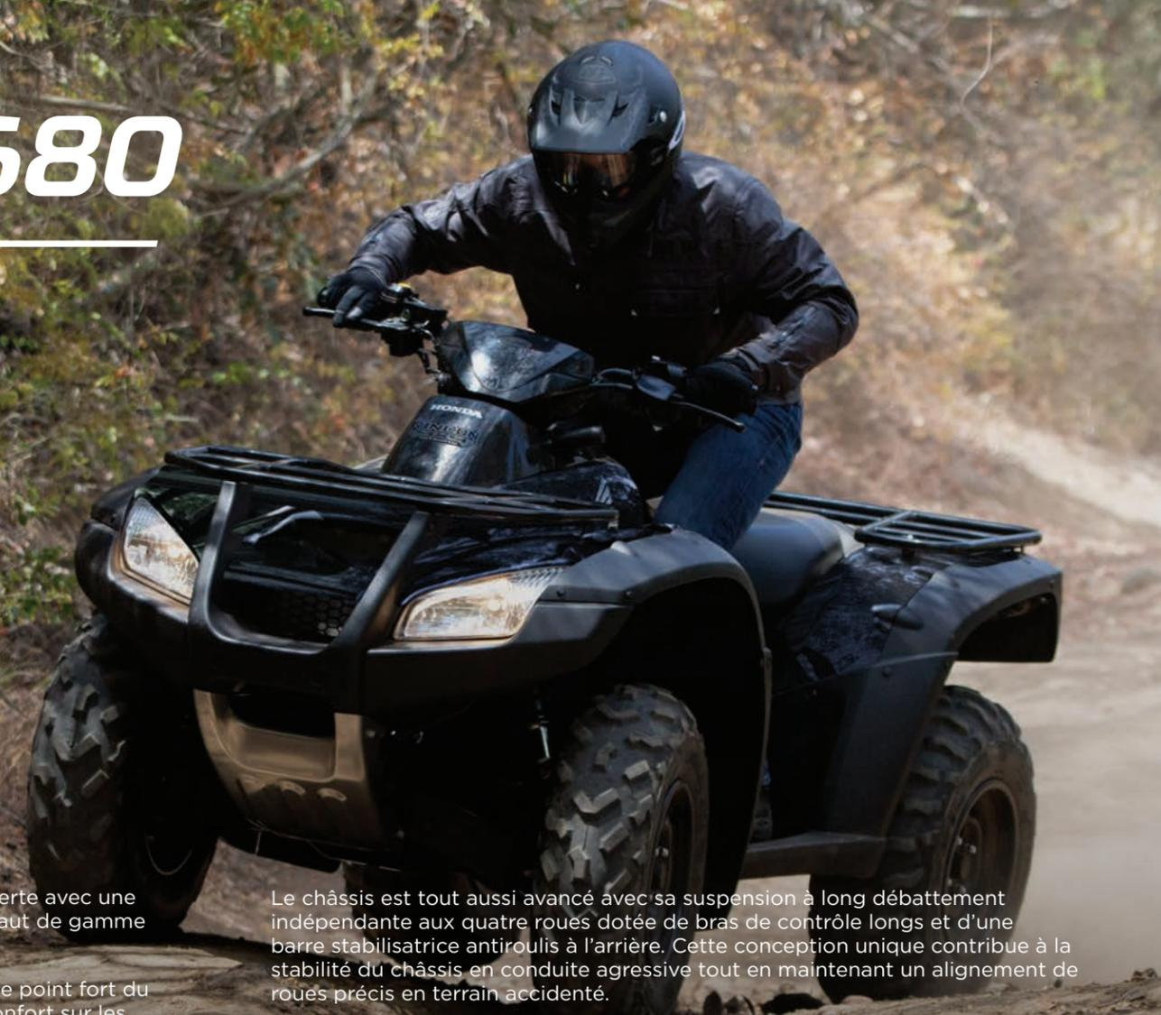
Le châssis est tout aussi avancé avec sa suspension à long débattement indépendante aux quatre roues dotée de bras de contrôle longs et d'une barre stabilisatrice antiroulis à l'arrière. Cette conception unique contribue à la stabilité du châssis en conduite agressive tout en maintenant un alignement de roues précis en terrain accidenté.
