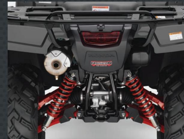
Nos VTT axés sur les sentiers sont équipés de suspensions arrière **indépendantes à doubles bras (IRS)** avancées de Honda qui assurent une superbe performance sur les terrains les plus difficiles et une conduite ultra-douce tout en maintenant la tenue et le contrôle pour lesquels tous les VTT Honda sont réputés.
