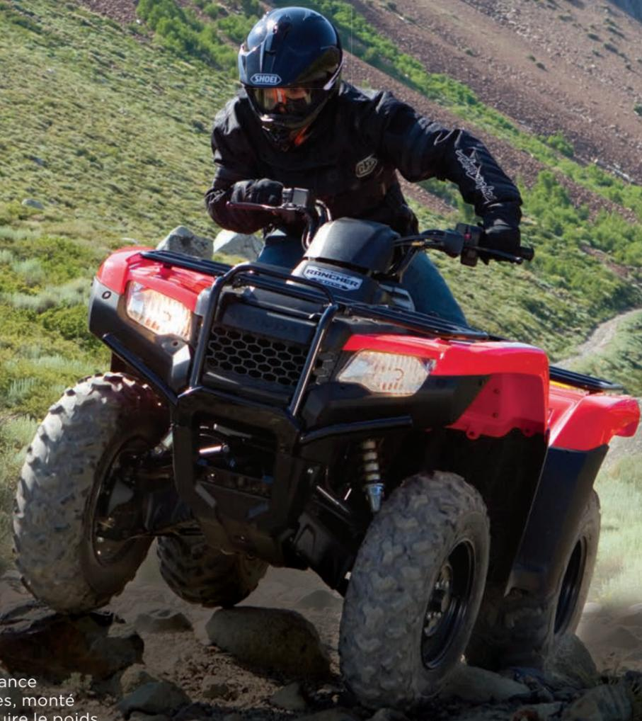
Le TRX420 Rancher<sup>MD</sup> standard est doté d'une direction non assistée et d'une transmission manuelle cinq vitesses, à sélecteur au pied et embrayage automatique, ainsi qu'une suspension arrière à bras oscillant et essieu rigide pour plus de stabilité en terrain accidenté ou lourdement chargé. C'est un ensemble à tout faire, simple, robuste, qui a prouvé sa valeur partout au Canada.
